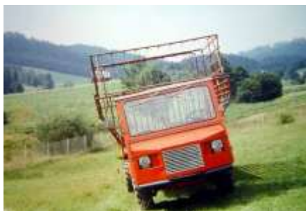
Fot. 40. Transporter górski Car-gotrak produkcji szwajcarskiej z nadwoziem samozbierającym
