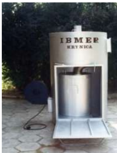
Fot. 85, 86. Nowa wersja konstrukcji pieca z wkładem trocinowym, obok suszarnia na owoce i warzywa z przyściennym kolektorem słonecznym wspomagana wymuszonym obiegiem powietrza ogrzanego w piecu z wkładem trocinowym
