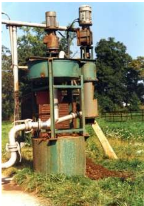
Fot. 83. Urządzenie do separacji gnojowicy. Prototyp urządzenia wdrażany w Instytucie Zootechniki w Zakładzie w Grodźcu Śląskim
