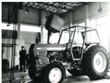
Fot. 44, 45. Próba uderzenia odciągniętym wahadłowo obciążnikiem o masie 2000 kg z przodu i z boku konstrukcji szkieletu kabiny ochronnej kierowcy
