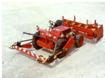
Fot. 42. Samojezdna kosiarka Heureka z przetrząsaczo-zgarniarką pasowo-palcową (Szwajcaria)
