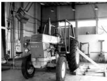
Fot. 44, 45. Próba uderzenia odciągniętym wahadłowo obciążnikiem o masie 2000 kg z przodu i z boku konstrukcji szkieletu kabiny ochronnej kierowcy
