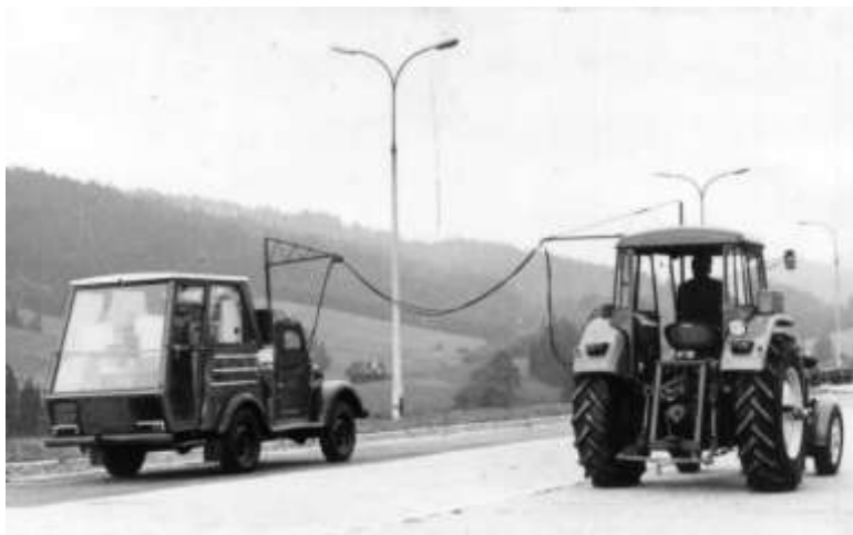
Fot. 14. Mobilne laboratorium podczas pomiarów charakterystyki trakcyjnej ciągnika.
