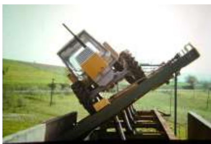
Fot. 52. Badania kąta stateczności poprzecznej ciągnika Ursus 1204 (4WD) na specjalnym stanowisku w Tyliczu
