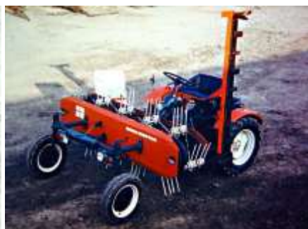
Fot. 43. Samojezdna kosiarka Reform z przetrząsaczo-zgarniarką czołową i bezpalcową kosiarką boczną (Austria)
