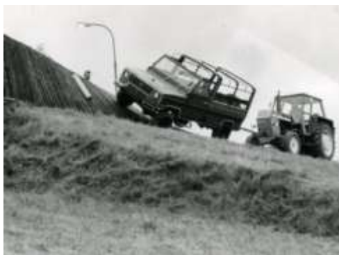
Fot. 47. Próba wymuszonego bocznego wywrotu ciągnika z zamontowanym szkieletem konstrukcji kabiny ochronnej kierowcy na stok na specjalnym stanowisku polowym
