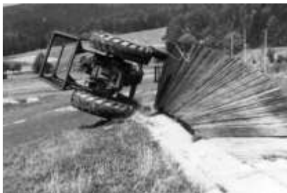
Fot. 47. Próba wymuszonego bocznego wywrotu ciągnika z zamontowanym szkieletem konstrukcji kabiny ochronnej kierowcy na stok na specjalnym stanowisku polowym
