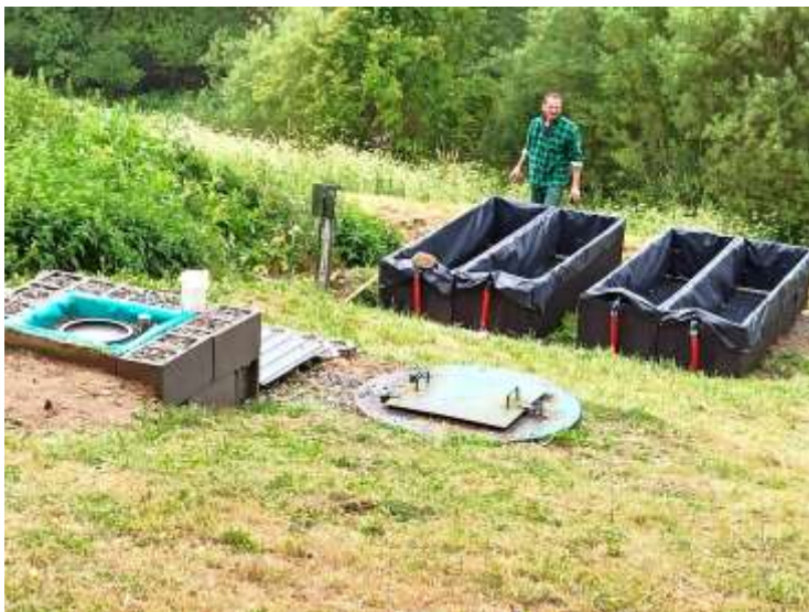
Fot. 105. Grzegorz Skalniak przy budowie stanowiska do badań skuteczności doczyszczania ścieków w przydomowych oczyszczalniach (2025 r.)
