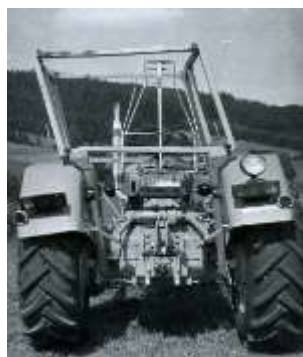
Fot. 46. Próba zgniatania części tylnej części konstrukcji szkieletu kabiny ochronnej obciążeniem równym dwukrotnej masie ciągnika. Obok widok bardzo odkształconego szkieletu kabiny po decydującej próbie uderzenia z boku. Mimo tego, widoczna wewnątrz ażurowa strefa ochronna kierowcy nie została w trakcie tej próby naruszona
