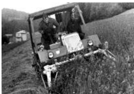
Fot. 24, 25. Technicy: Andrzej Hobora i Jerzy Parfianowicz oraz Tadeusz Sapek podczas testowania nieudanych konstrukcji kosiarek górskich z Bułgarii
