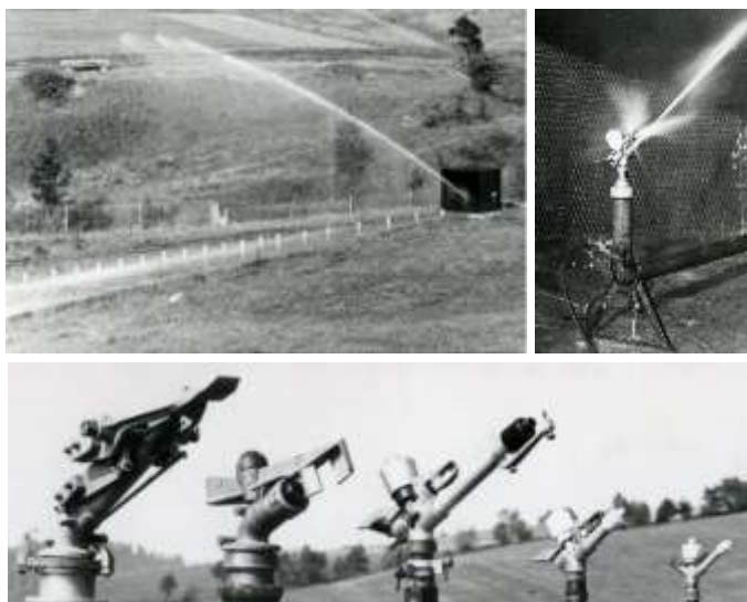
Fot. 18. Stanowisko do badań równomierności wysokości opadu na powierzchni nawadnianej badanym zraszaczem deszczowni polowej. Poniżej asortyment badanych zraszaczy i armatek wodnych.
