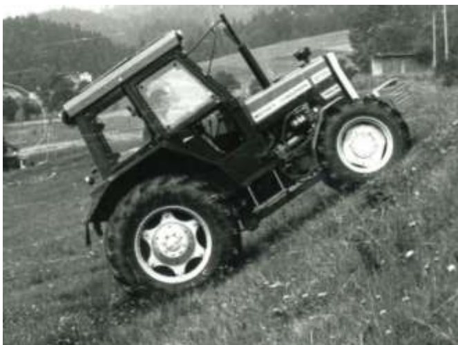
Fot. 51. Badanie terenowe możliwości trakcyjnych ciągnika MF 255 z napędem 4x4 podczas podjazdu na stromą skarpe. Odważnym operatorem ciągnika był technik Jan Klimkowski
