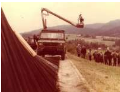
Fot. 48, 49, 50. Próba wymuszonego bocznego wywrotu samochodu woj- skowego Honker 4WD na stok w celu oceny wytrzymałości konstrukcji ochronnej kabiny kierowcy podczas ewentualnego wypadku w czasie jazdy terenowej
