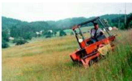
Fot. 34, 35. Harnaś z prototypem czołowej kosiarki dwulistwowej (bezpalcowej) o szerokości roboczej 2,0 m
