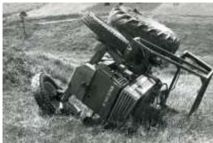
Fot. 47. Próba wymuszonego bocznego wywrotu ciągnika z zamontowanym szkieletem konstrukcji kabiny ochronnej kierowcy na stok na specjalnym stanowisku polowym
