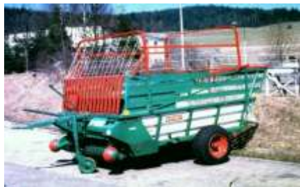
Fot. 37. Przyczepa samozbierająca o objętości 9,1 m 3 przeznaczona do współpracy z HARNASIEM (POM Opalenica)
