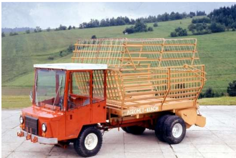
Fot. 38. Górski Wielozadaniowy Transporter Rolniczy (GWTR) z wy- miennie nabudowywanym nadwoziem samozbierającym.
