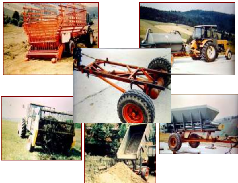
Fot. 39. NG-2 z kompatybilnym zestawem nabudowywanych maszynowych nadwozi w technologicznym układzie: jedno podwozie + szybko wymienne maszynowe nadwozia o ładowności do 2000 kg
