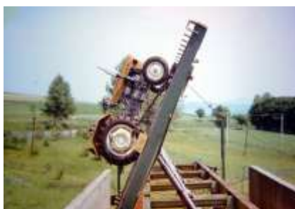
Fot. 53. Badanie kąta stateczności podłużnej ciągnika Ursus C-355
