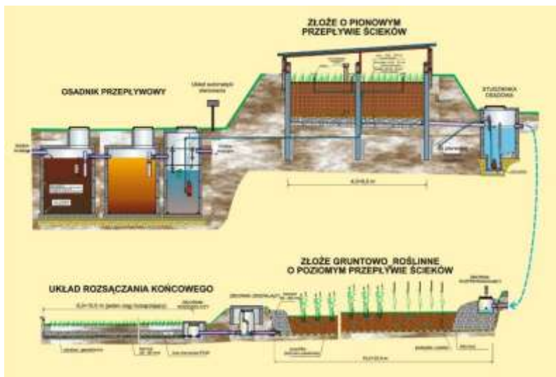
Rys. 4. Projekt wieloczęłowej oczyszczalni ścieków bytowych do 50 RLM
