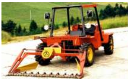
Fot. 34, 35. Harnaś z prototypem czołowej kosiarki dwulistwowej (bezpalcowej) o szerokości roboczej 2,0 m
